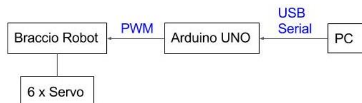
Figure 16 - Illustration du système Miroir braccio. Source : https://github.com/ohlr/braccio_arduino_ros_rviz
