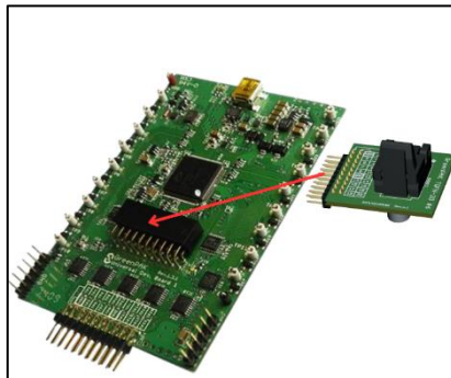
Figure 2 : Branchement Adaptateur - Carte de développement
