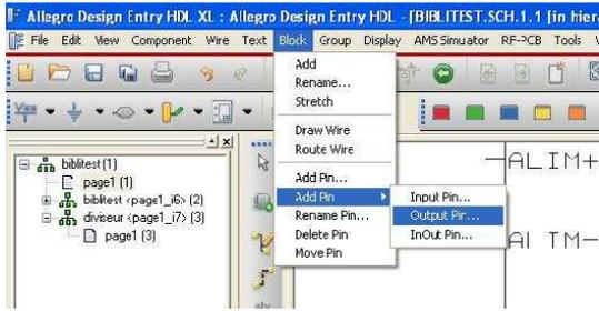
Faire « Block - Add Pin » et choisir « Input Pin », « Output Pin », ou « InOut Pin ». Nommer vos ports et placer-les sur le bloc.
