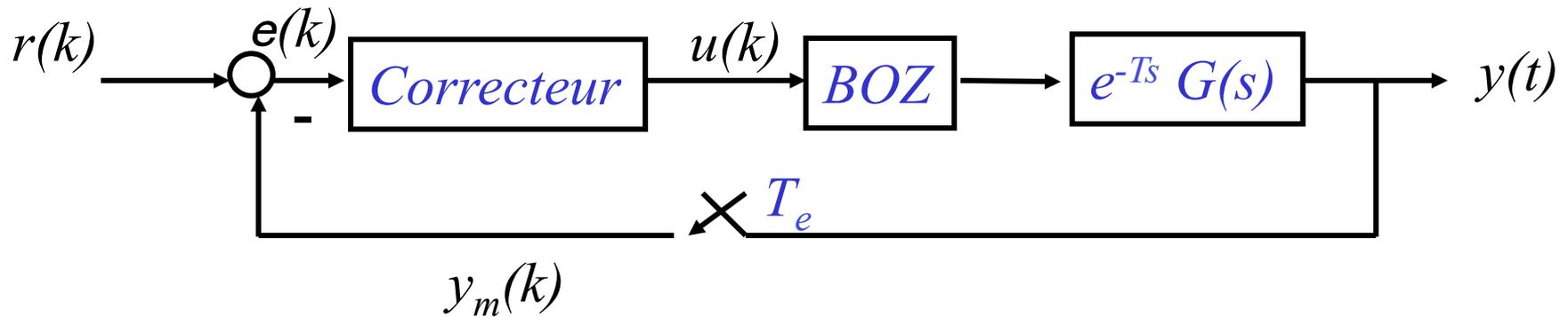
Fonction de transfert du système (boucle ouverte):  $= z^{-d} (1 - z^{-1}) Z \left\{ \frac{G(s)}{s} \right\}$
