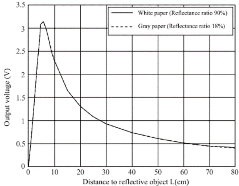
La fonction tension-distance n'est pas une bijection et par conséquent, son inverse n'existe pas. C'est pourquoi nous n'allons considérer que la partie de la courbe allant de 10 [cm] jusqu'à 80 [cm]. Dans cette plage, la fonction tension-distance peut être approchée par la fonction suivante :
