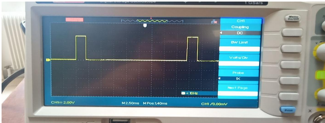
Figure 1: Visualisation du signal PWM d'une période 22ms et un état haut de 2ms par l'oscilloscope.
