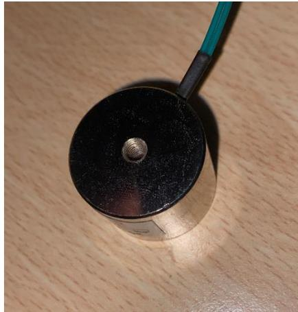
On peut utiliser ce trou taraudé pour fixer l'électro-aimant avec une plateforme comme sur la photo par exemple :
