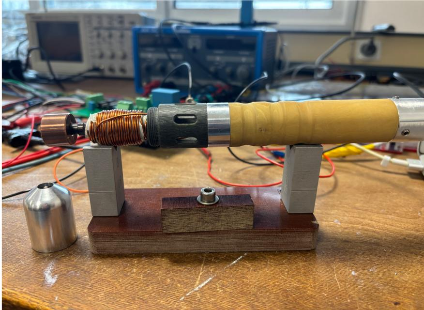
Après un calcul théorique et une mesure avec un instrument, l'inductance de cette bobine est égale à :  **$L = 80 \mu\text{H}$**
