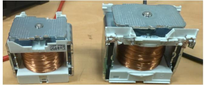
(b) Architecture du circuit magnétique - SIEMENS "0LA2"
