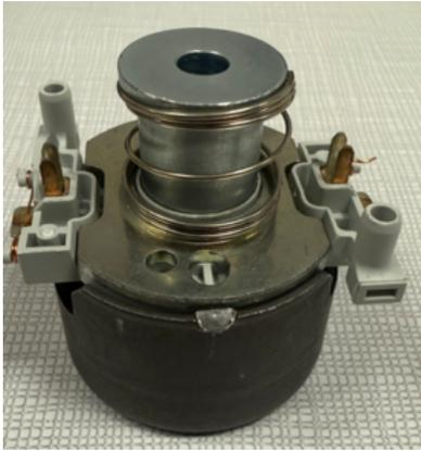
(a) Architecture du circuit magnétique - ABB AF09Z-22-00-30
