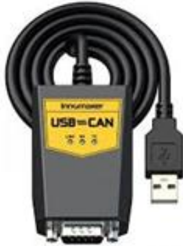
Figure 12. Adaptateur pour communiquer entre BMS et ordinateur
