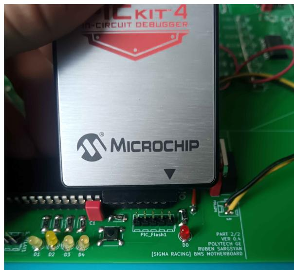
Figure 5: Connexion du PICKit 4 au microcontrôleur.
