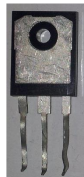
Figure 1 - La semelle métallique de l'IGBT connectée au collecteur
