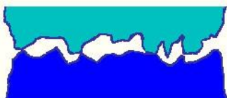
Figure 2 - Schéma contact entre deux pièces de métal
