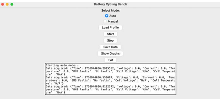
Figure 29. Acquisition de données lancées sur l'IHM
